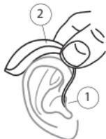
1. Introduzca el adaptador de oído en la oreja mientras sujeta la parte inferior del tubo/cable auditivo. Puede que le ayude si lleva la oreja hacia arriba y atrás.
