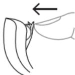
Para encender el audífono, cierre el compartimento de la pila. El audífono emitirá una señal sonora para indicar que está encendido, a no ser que el audioprotesista haya desactivado esta función.
