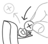
Después, coloque la pila en el compartimento como se muestra en la ilustración. Cierre el compartimento de pila. Si no es fácil cerrar el compartimento de pila, ésta no está bien colocada.
